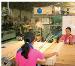
印刷シートラッピング機での検品
