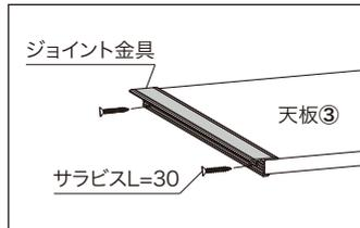
ジョイント金具をベースセット(①)の天板に付属のサラビスL=16で取り付けます。
