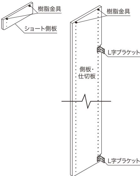
**L字ブラケット** 上側:切り欠き部分ダボ穴、下側:1番下のダボ穴に固定してください。
