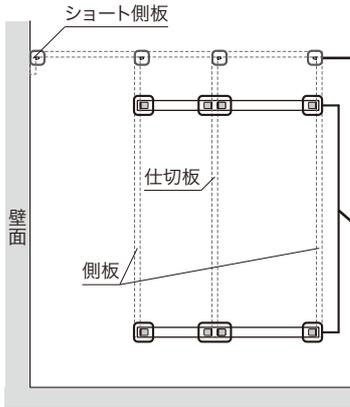
**樹脂金具** 上から1番目のダボ穴、前後2箇所に樹脂金具を取り付けます。樹脂金具の正円に向かってバインドビスL=16で固定してください。
