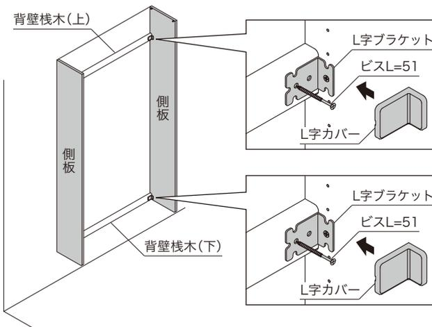
3 壁面へショート側板の固定( 両側壁納め 片側オープン の場合のみ)
