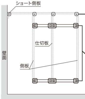
**樹脂金具** 上から1番目のダボ穴、前後2箇所樹脂金具を取り付けます。樹脂金具の正円に向かってバインドビスL=16で固定してください。
