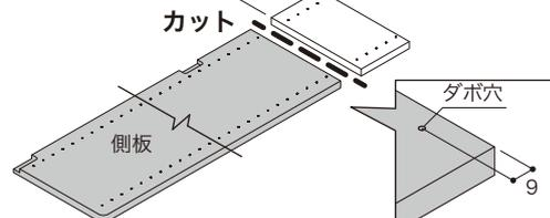
1 側板へ隙間かくし材の貼り付け(背板パネルを設置する場合 ※オープンスペースを設ける場合のみ)
