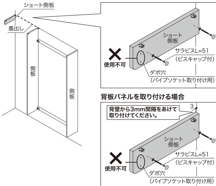
側板・ショート側板の取り付けが完了したら 5 仕切板の取り付け P14
