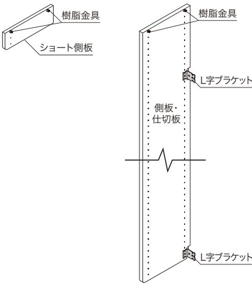
**L字ブラケット** 上側:切り欠き部分ダボ穴、下側:1番下のダボ穴に固定してください。
