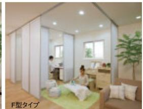
将来の空間の使い方を想像し、設計段階で間仕切パネルを配置したい位置まで、上レールを設置しておきます。こうすることで、大掛かりな工事をすることなく、間仕切パネルの配置を変えるだけで、簡単に間取りチェンジができます。
