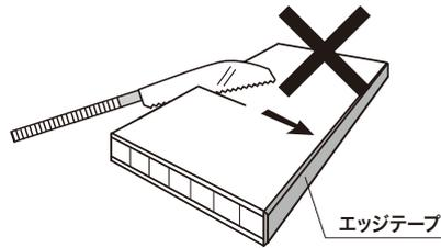
アートランバーの幅方向をカットする場合、必ずエッジテープのある側からカットを始めてください。
