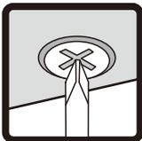
電動ドライバー等、トルクの強い工具で施工する場合、ネジ山が損傷しないよう注意してください。ビスの保持力を損なう危険性があります。
