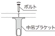
もう片方の両端ブラケットをパイプへ差し込み、棚板上部からボルトで固定します。
