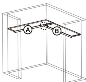
L字に交差する部分の補強として、①受棧裏から交差する②前框の断面に向かってφ3mm位の下穴を開けた後、ビスL=65以上(現場調達)を打ってください。
