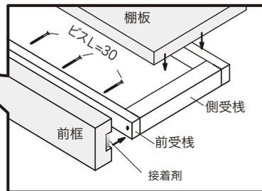
1.前枠を前受棧に取り付けます。前枠裏面に接着剤を塗布後、前受棧裏面より前枠と前受棧をしっかり押さえてφ3mm位の下穴を開けた後、ビス止めしてください。
