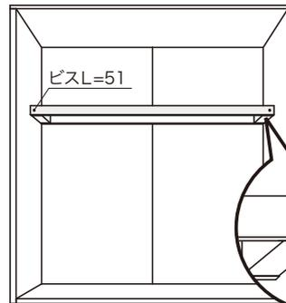
前受棧を間口寸法にカットし、左右側受棧木口中央部にφ3mm位の下穴を開けた後、ビス止めしてください。
