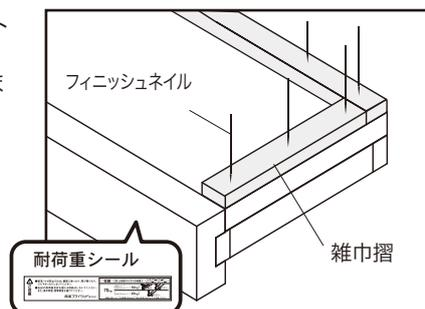
雑巾摺りを寸法取り後、切断し枕棚上の壁際にそってフィニッシュネイル(現場調達)で取り付けてください。
