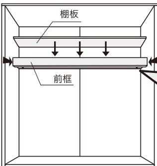
前框の寸法を取り、カットしてください。「枕棚仕上がり奥行」-27mmが棚板奥行寸法です。
