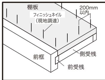
2.棚板を受棧上面に設置します。棚板をフィニッシュネイル(現場調達)で、受棧に固定してください。(ピッチ200mm以内)
