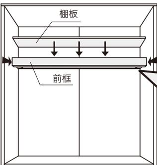
前枠・棚板の寸法を取り、カットしてください。
