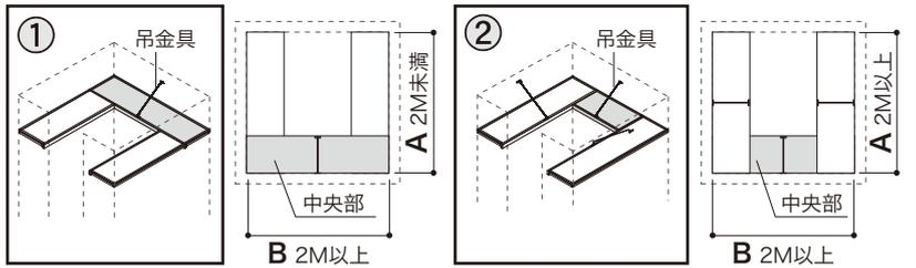
注意 A/Bの両方が2M以上の場合は、必ず②の組み方にて施工してください。
