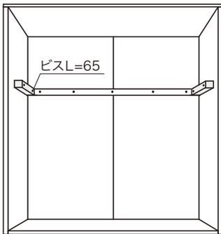
左右の側受棧にφ3mm位の下穴を開けた後、両側壁面にワッシャーを通したビスで止め、ビスキャップを取り付けてください。
