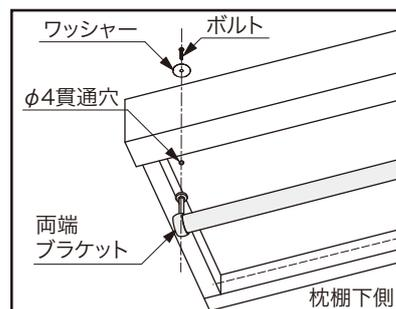
カットしたパイプをブラケットに取り付け、枕棚にあけた穴に同梱のボルトで取り付けます。
