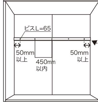
後受棧を間口寸法にカットし、前枠位置を確認の上、φ3mm位の下穴を開けた後、後壁面にワッシャーを通したビスで止め、ビスキャップを取り付けてください。(ビス止めピッチ・450mm以内)
