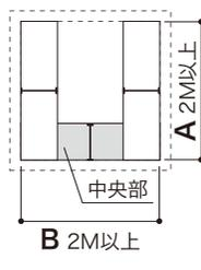
注意 A/Bの両方が2M以上になる場合は、必ず②の組み方にて施工してください。
