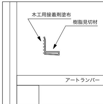
樹脂見切材に木工用接着剤を塗布し、アートランバーに取り付けます。
