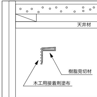
樹脂見切材に木工用接着剤を塗布し、天井材に取り付けます。
