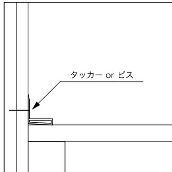
樹脂見切材をタッカー、又はビスで、下地に固定します。(固定ピッチ=450mm以内)
