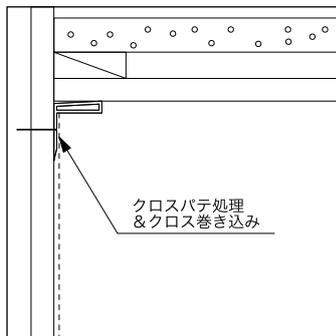
樹脂見切材の垂直部分にクロスパテ処理を施し、クロスを巻き込みます。
