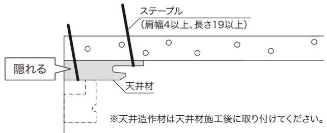
メスサネ部をステーブルで固定していきます。ステーブルは右図のように、野縁だけでなく、野縁と野縁の間(下地は無くて良い)に200mmピッチ以内の間隔で打ってください。短手は下地の有無にかかわらず、中央に1本打ってください。
