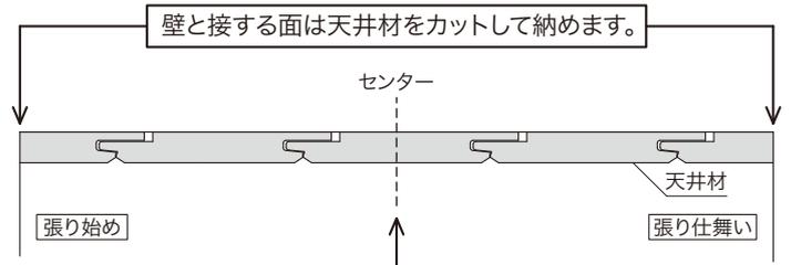
上図のようにセンターを起点として、天井材を割り付けると綺麗に仕上げることができますので、センター割り付けをおすすめします。
