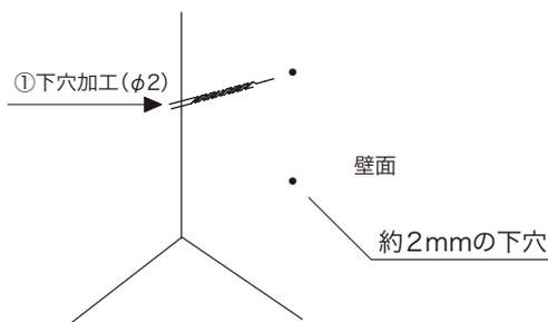
②L=25のビスを下図のようにビス頭までL型アンゲル棚受に入れてから下穴へドライバーにて取り付けてください。
