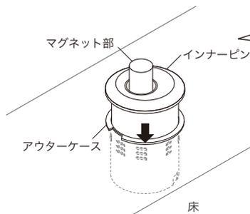
マグネット部が扉(連動タイプ)のセンターにくるように、インナーピンを回転させて向きを調整してください。(インナーピンの回転でマグネット部の位置を  $\pm 2\text{mm}$  移動できます。)
