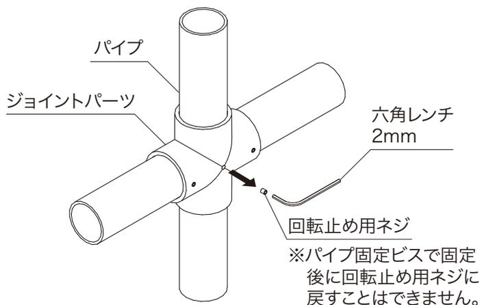
2 パイプ固定ビスで、パイプとジョイントパーツを固定します。
