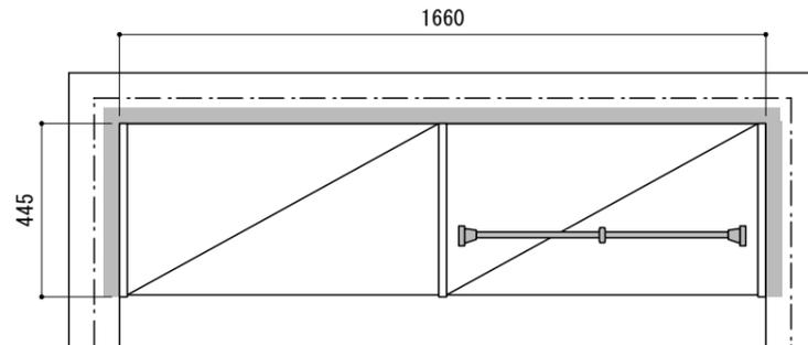
背壁 桟木を取り付ける部分に12mm厚以上の合板もしくは補強桟木（現場調達）で下地補強をしてください。
